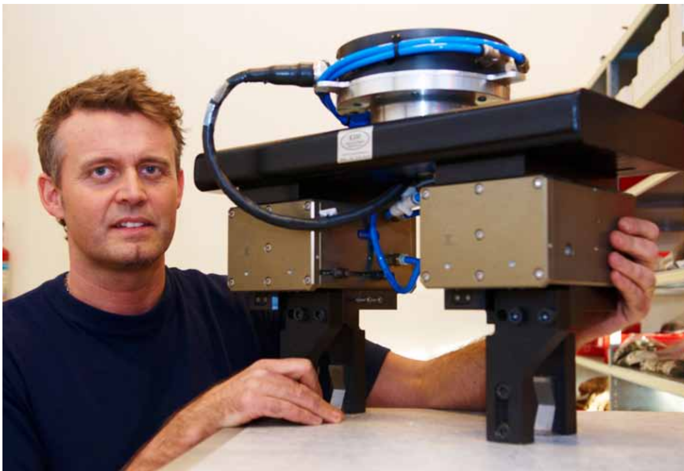
TIL ROBOT: Slike har vi laget mange av, forteller produksjonsleder Sindre Solbakken. Dette er en akselgriper for en robot. Vi har tegnet den i 3D og laget den på verkstedet.
