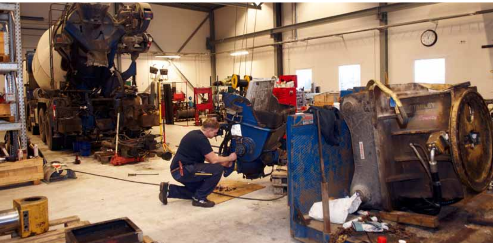
MEKANIKER: Vidar Rise er i gang med en reparasjon av pumpesystemet på en sementpumpebil. Verkstedet er så stort at hele bilen blir kjørt inn, og traverskrana brukes ved demontering og montering av utstyr.
